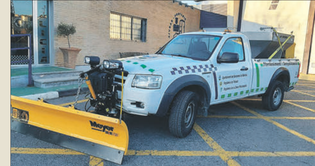
La pala s’adapta al frontal del vehicle tot terreny.
